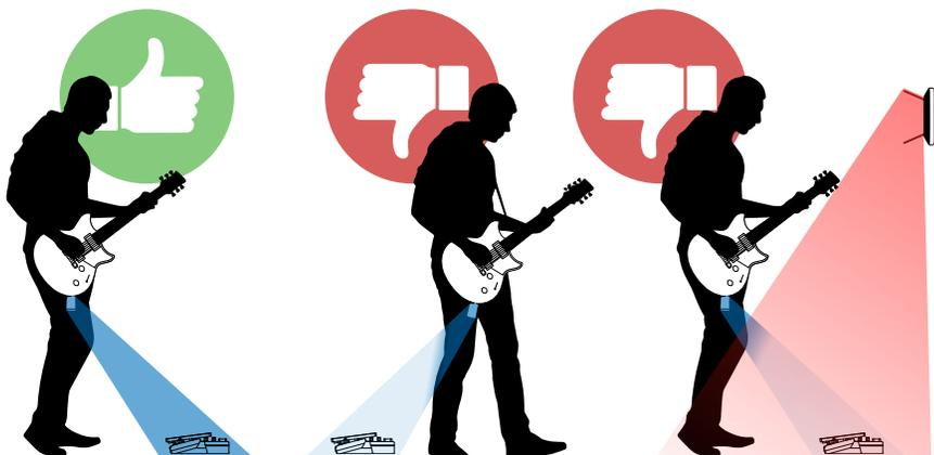
Pour un résultat optimal, veillez à ce qu'il n'y ait pas d'obstacles entre l'émetteur sans fil G10TII et l'antenne située au-dessus de la pédale d'expression. Le POD Go Wireless a une portée allant jusqu'à 30 mètres (sans obstacle).
